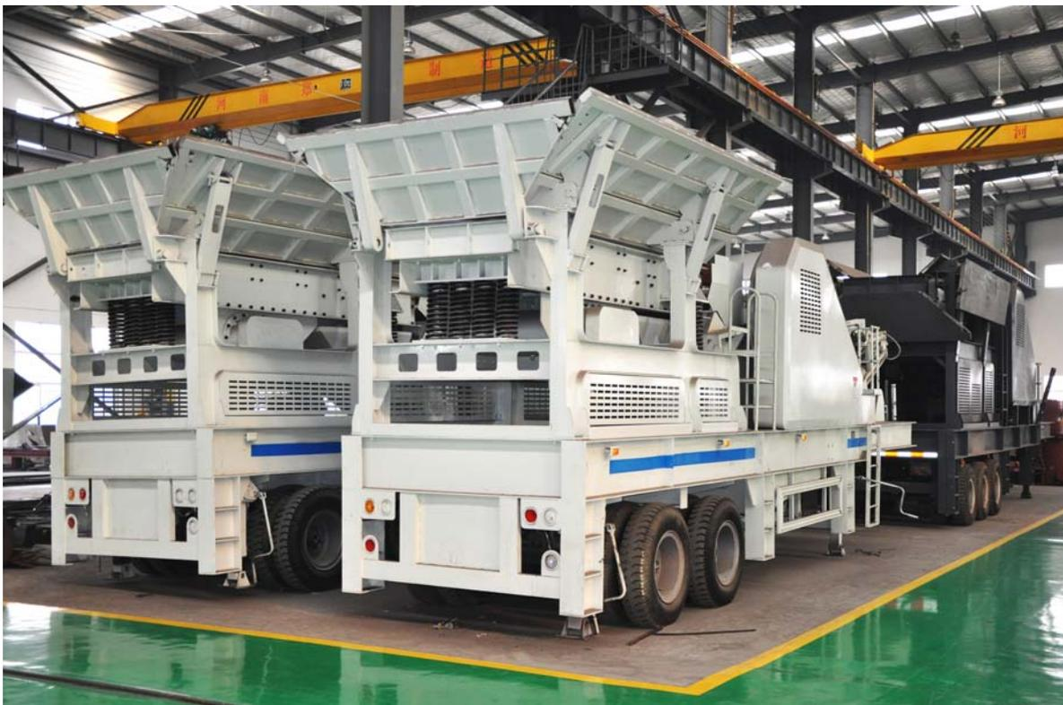
轮胎式移动破碎站又称半移动破碎站，是黎明重工科技开发推出的系列化岩石及建筑垃圾破碎设备，大大拓展了粗碎、细碎作业概念领域。它的设计理念宗旨是站在客户的立场，把消除破碎场地、环境、繁杂基础配置及繁杂物流带给客户破碎作业的障碍，作为首要的解决方案，通过一体化的车载系统实现设备的灵活移动，从而实现破碎工作的迅速、及时开展，为施工节省了大量的时间和原材料运输费用。本着物料“接近处理”的新概念原则，真正为客户提供简捷、高效、低成本的项目运营硬件设施。
