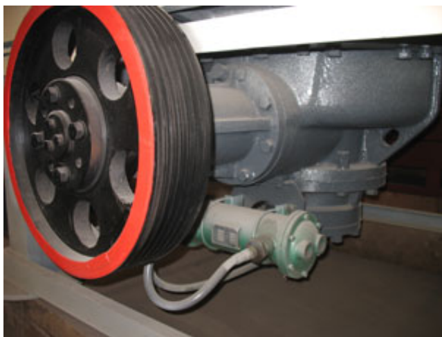
内部稀油润滑系统-及-锥齿轮传动装置
